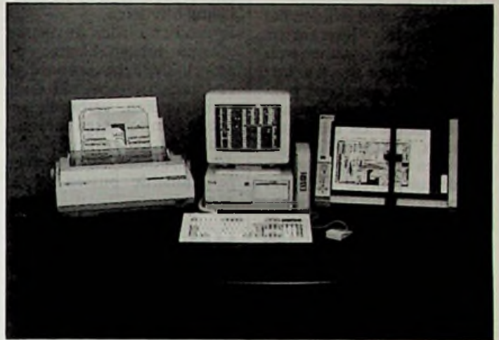
Afb. 1 Een typische hardware-configuratie voor het starten met het gecomputeerd ontwerpen van schema's en printplaten.
